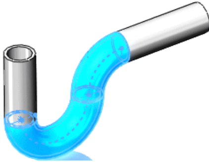
Skizzenbasierte Features: Ausgetragene Basis für das Abflussrohr
