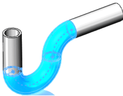
Funzioni basate su uno schizzo: Sweep di base per il tubo di scarico
