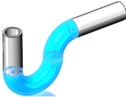
スケッチベース フィーチャー：排水パイプのベース スイープ
