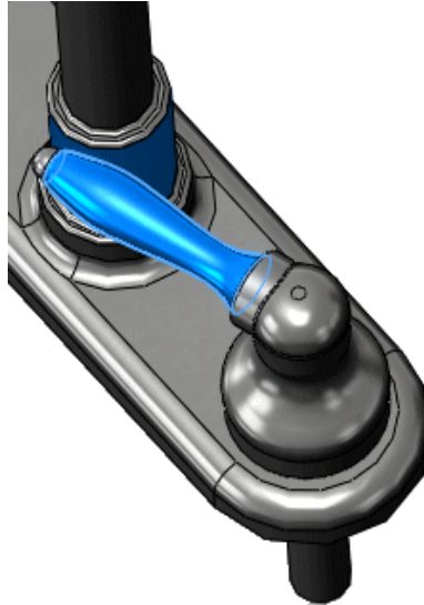
衝突検知、衝突面で停止オプションをオンにした蛇口アセンブリ
