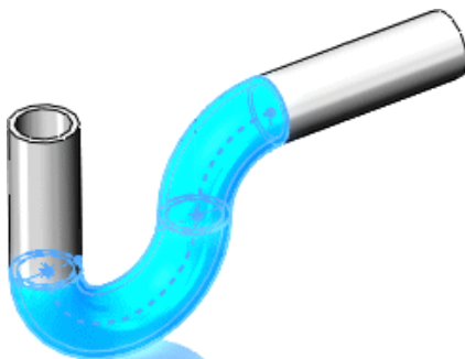
Operaciones basadas en croquis: Barrido de base para una cañería de desagüe
