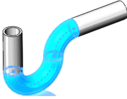
Çizim tabanlı unsurlar: Atık borusu için taban süpürme
